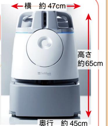
清掃ロボットを人が押して、ルートを記録させると2回目以降からはスタートボタンを押すだけで自立清掃します。
